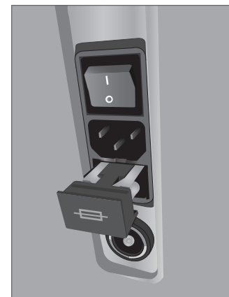
Ubicación del fusible
