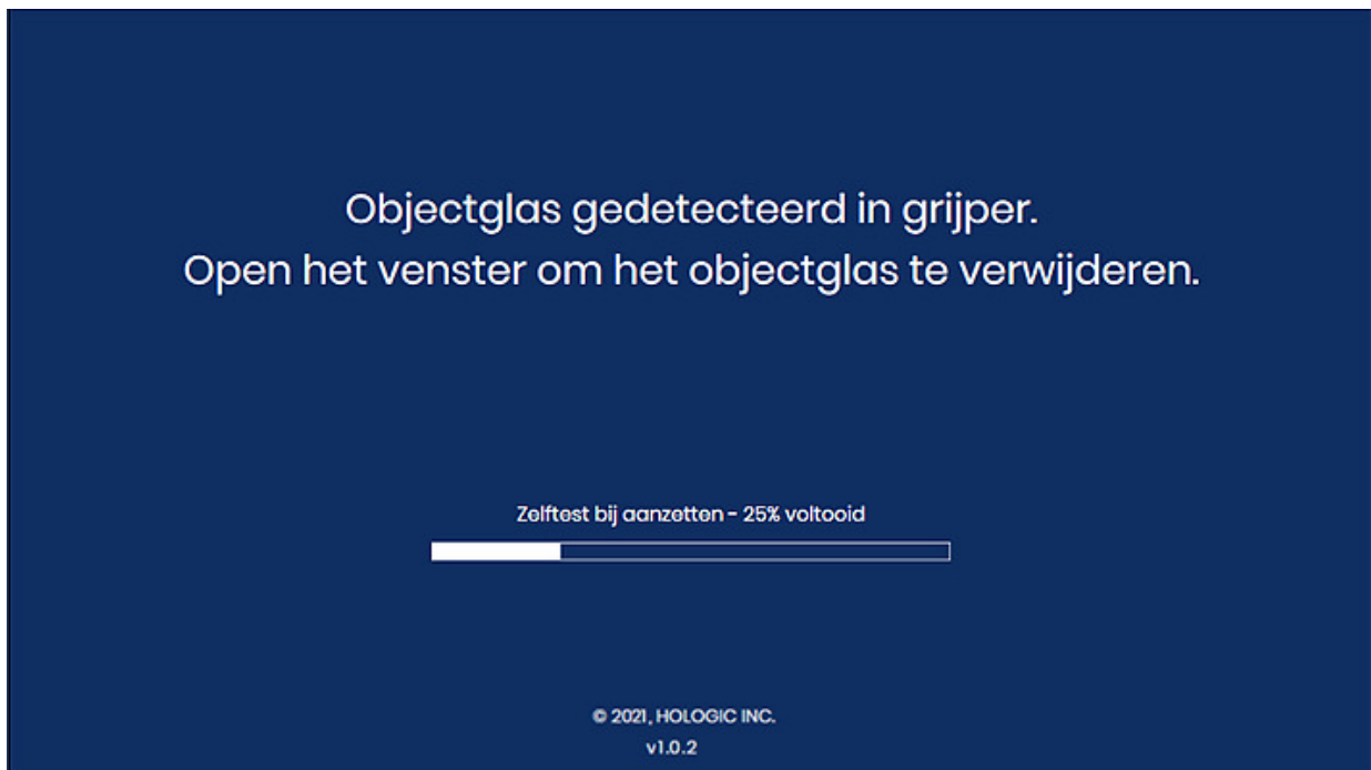
Afbeelding 6-6 Fouterstel met tussenkomst van de gebruiker: Open het venster om het objectglas te verwijderen
