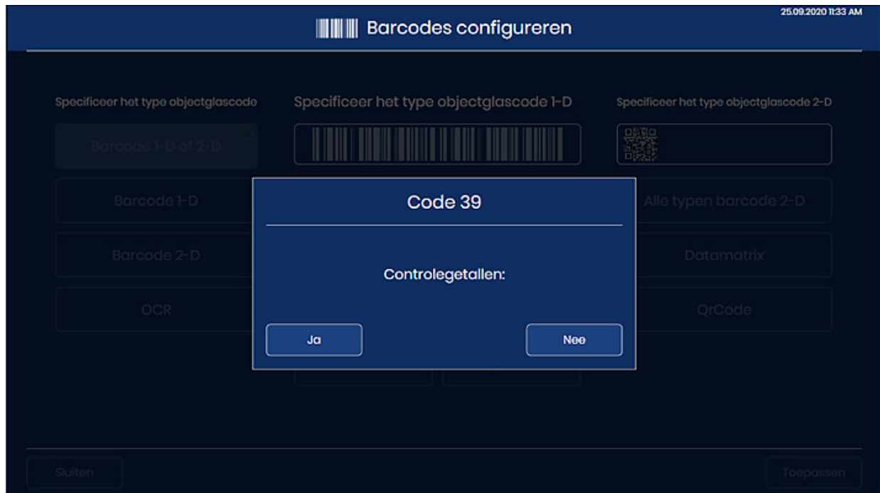
Afbeelding 3-27 Barcodes configureren: Gebruik van controlegetallen voor Interleaved 2 of 5 en voor Code 39 kiezen
