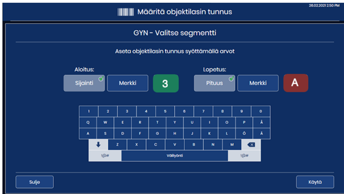
Kuva 3-30 Määritä objektilasin tunnusasetus: vihreä ilmaisee, että merkintä on kelvollinen
