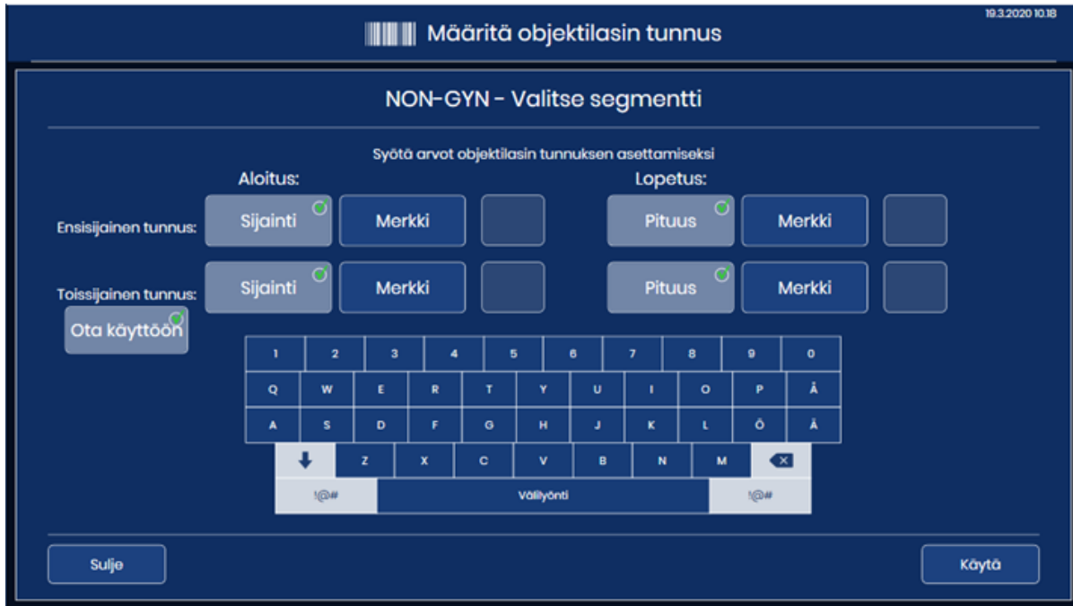
Kuva 3-33 Määritä objektilasin tunnus Non-Gyn-objektilaseille ensisijaisella tunnuksella ja toissijaisella tunnuksella
