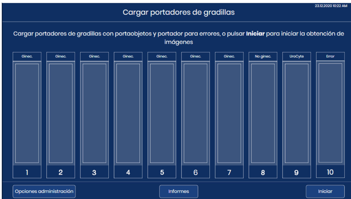
Figura 4-11 Iniciar la obtención de imágenes de portaobjetos: cargue portadores de portaobjetos o pulse Iniciar
