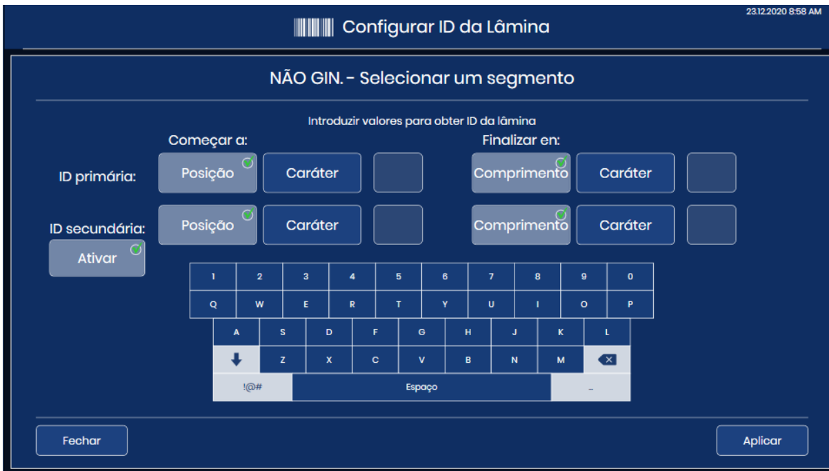
Figura 3-33 Configurar ID da Lâmina para Lâminas Não Gin. com ID primária e ID secundária
