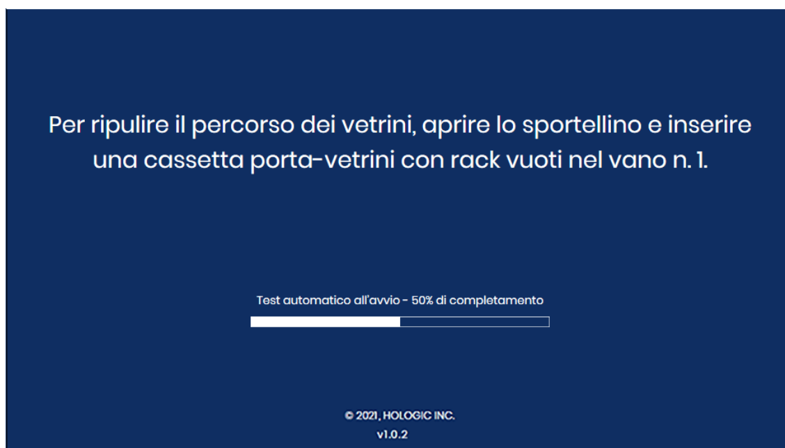
Figura 6-5 Ripristino in seguito ad un errore assistito dall'utente: caricare una cassetta porta-vetrini vuota
