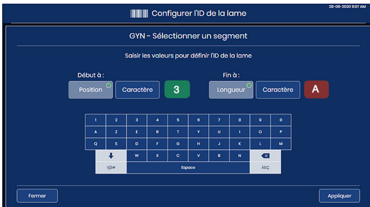
Figure 3-30 Paramètre de modification Configurer l'ID de la lame : vert pour une saisie valide
