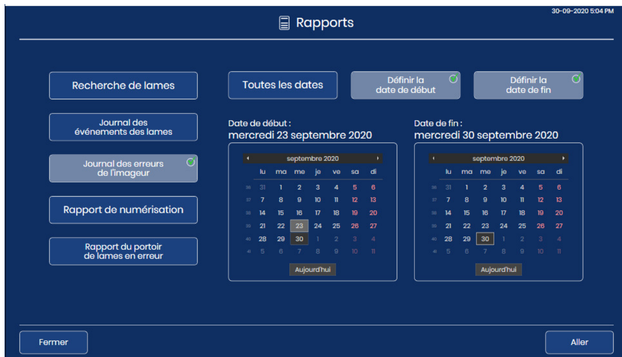
Figure 3-44 Journal des erreurs de l'imageur : définir la plage de dates, toucher Aller
