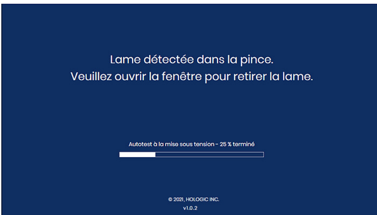
Figure 6-6 Récupération d'une erreur assistée par l'utilisateur : ouverture de la fenêtre pour retirer une lame
