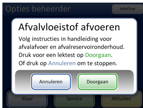
Afbeelding 8-9 De afvalfles legen en onderhoud plegen
