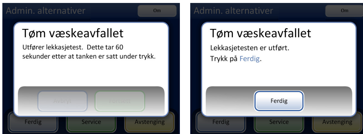
Figur 8-12 Lekkasjetest av avfallssystemet
