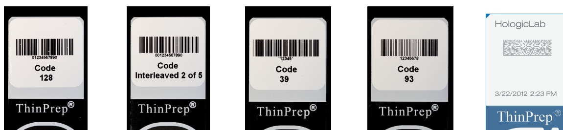
Figur 7-3 Eksempler på, hvordan strejkoder sættes på et ThinPrep-objektglas
