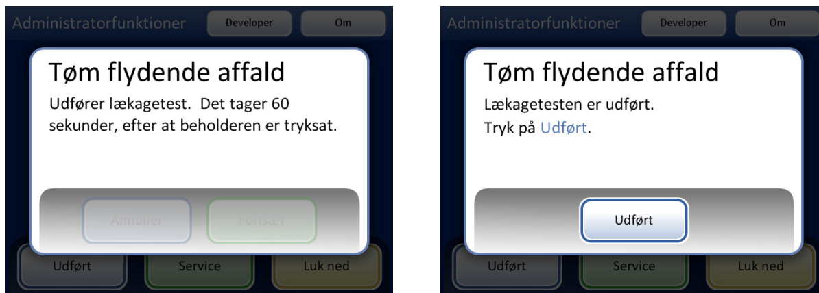
Figur 8-12 Lækagetest af affaldssystemet
