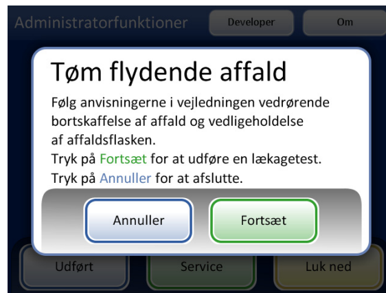
Figur 8-9 Tøm og vedligehold affaldsflasken
