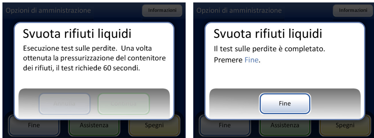
Figura 8-12 Test sulle perdite del sistema di scarico
