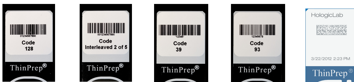
Figura 7-3 Esempi di applicazione di etichette con codici a barre su un vetrino ThinPrep
