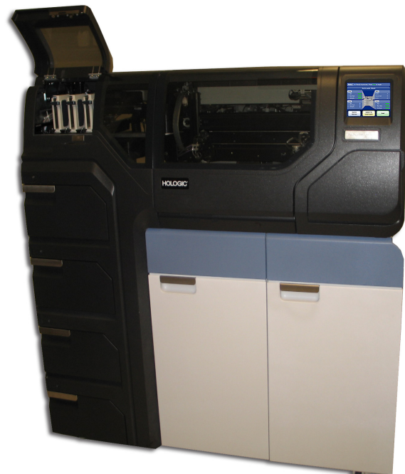
Figur 2-1 En typisk ThinPrep™ 5000-prosessor med AutoLoader
