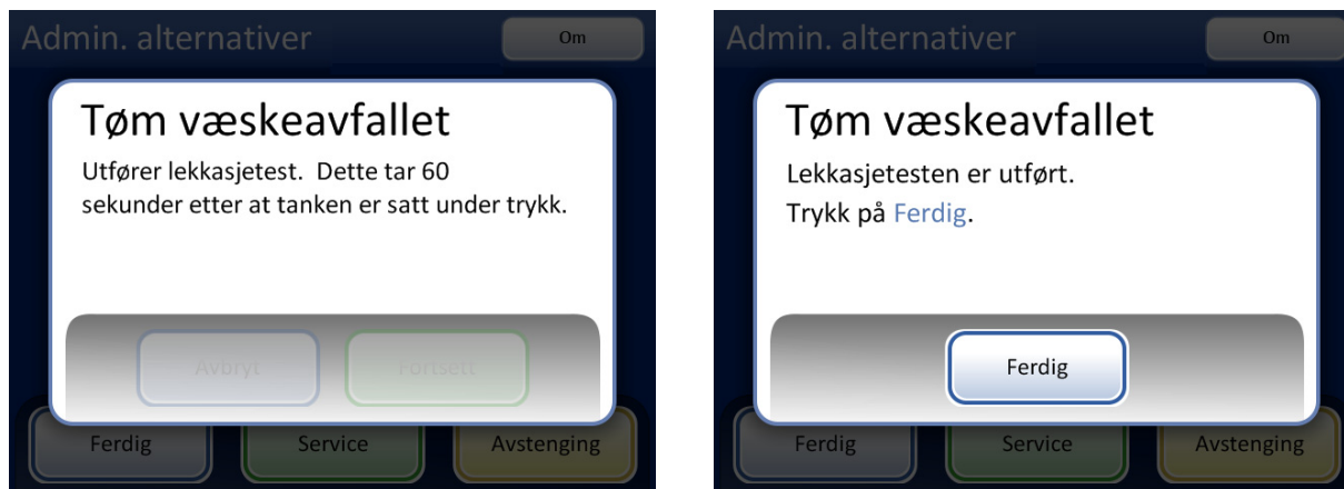
Figur 8-15 Lekkasjetest av avfallssystemet
