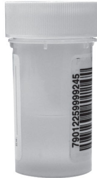
Etiqueta de código de barras: vertical, lisa, alineada con la etiqueta de la solución PreservCyt®.
