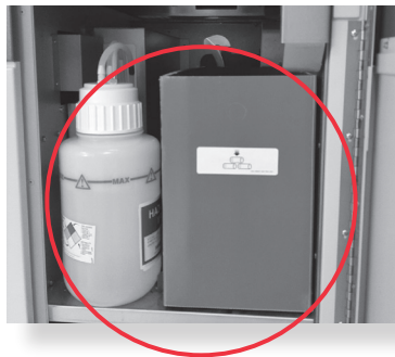
Vaciado del contenedor para residuos del filtro
