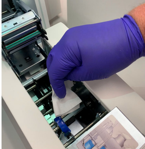
Kuva 8-10 Pyyhi aluslasin tulostimen kuljetusrullat
