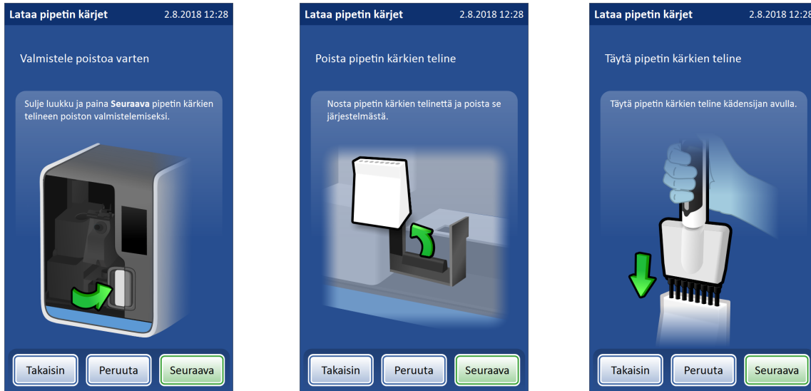
Kuva 7-11 Aseta pipetin kärjet pipetin kärkien telineeseen
