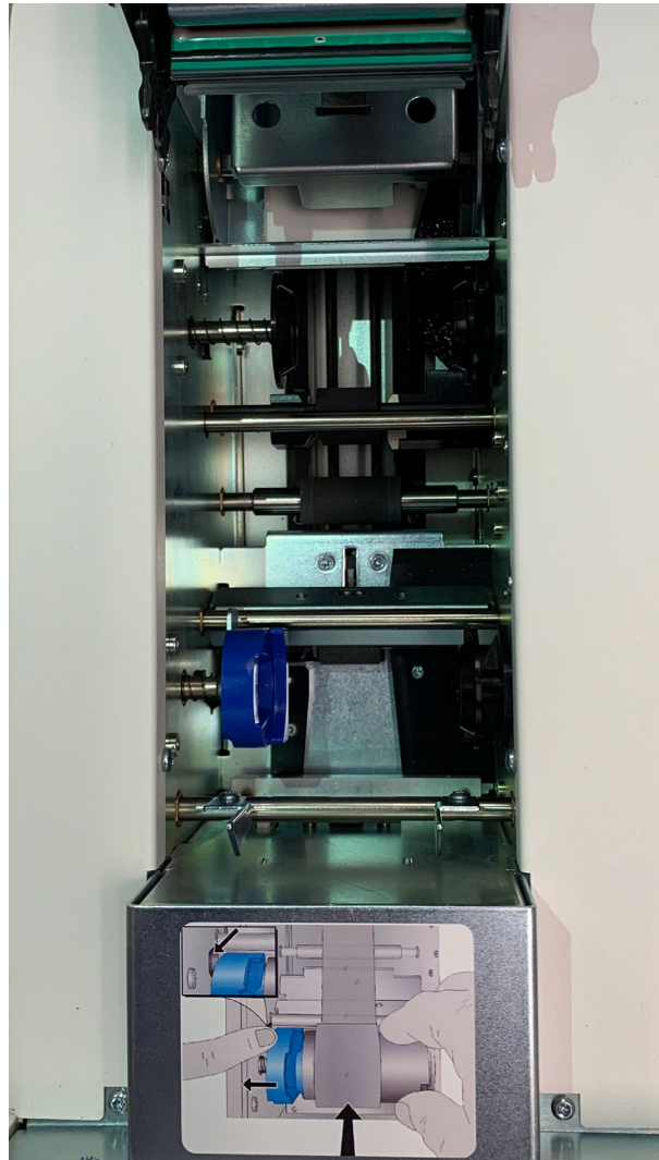
Kuva 8-9 Aluslasin tulostimen kuljetusrullat
