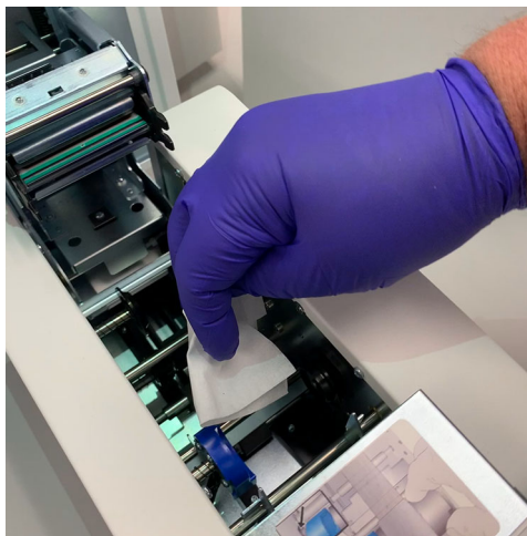
Figur 8-10 Tørk av objektglasskriverens transportvalser
