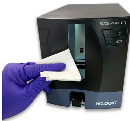
Figur 8-11 Rengjør innmatingsvalsen på objektglasskriveren
