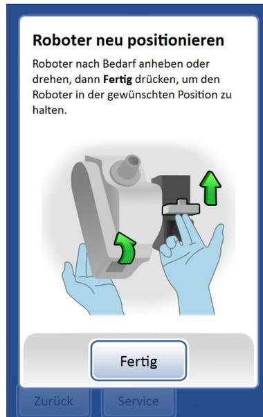
Nach Drücken auf die Taste **Roboter neu positionieren** die Robotervorrichtung mit sanftem Druck drehen oder auf und ab bewegen. Die Robotervorrichtung kann sich nach links und rechts drehen.
