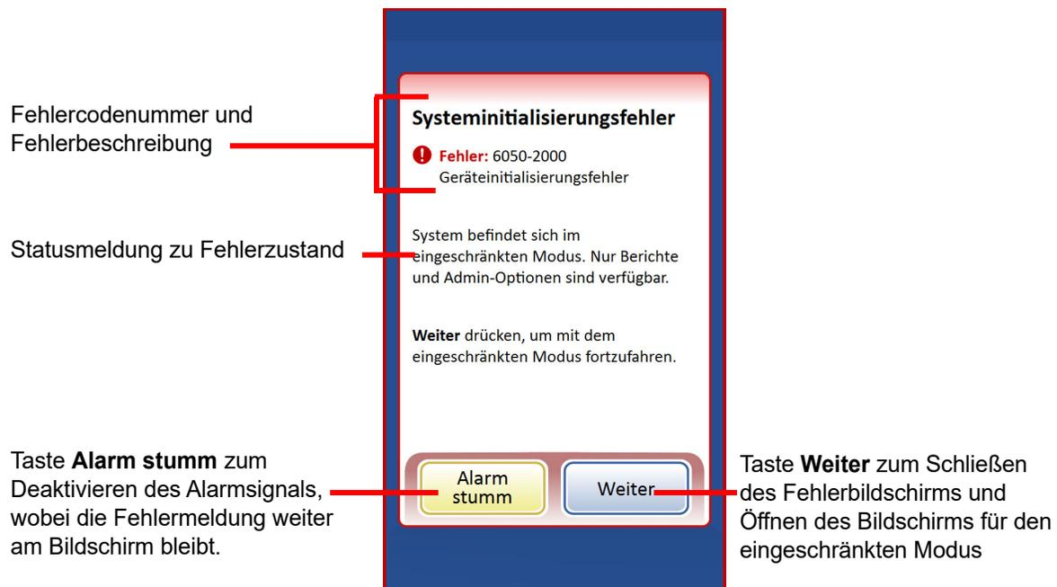
**Abbildung 9-11 Das System hat einen Fehler entdeckt**
