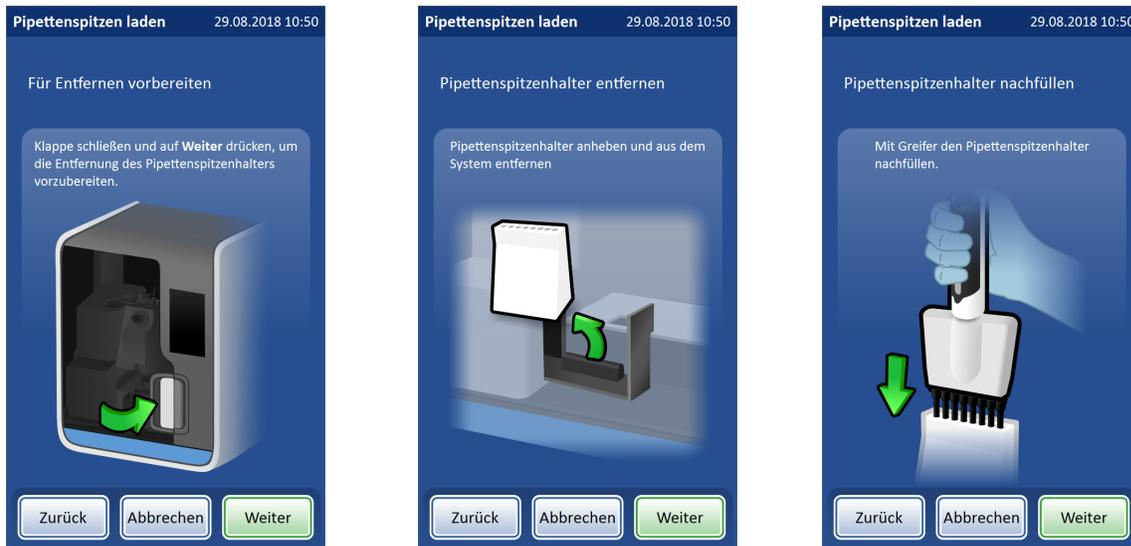
**Abbildung 7-11 Die Pipettenspitzen in den Pipettenspitzenhalter laden.**
