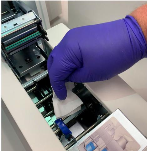
**Abbildung 8-10 Transportrollen des Objektträgerdruckers abwischen**
