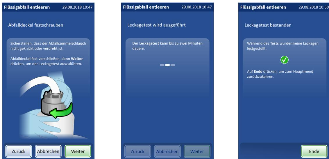
**Abbildung 8-17 Deckel festdrehen und Leckagetest des Abfallsystems durchführen**
