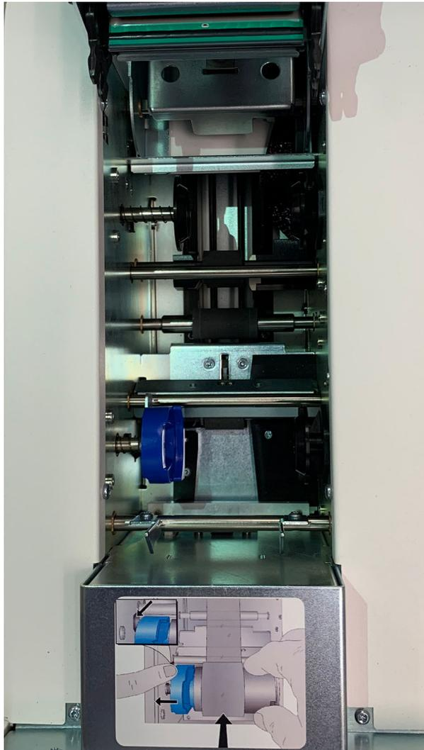
**Abbildung 8-9 Transportrollen des Objektträgerdruckers**
