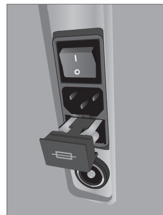
Emplacement du fusible
