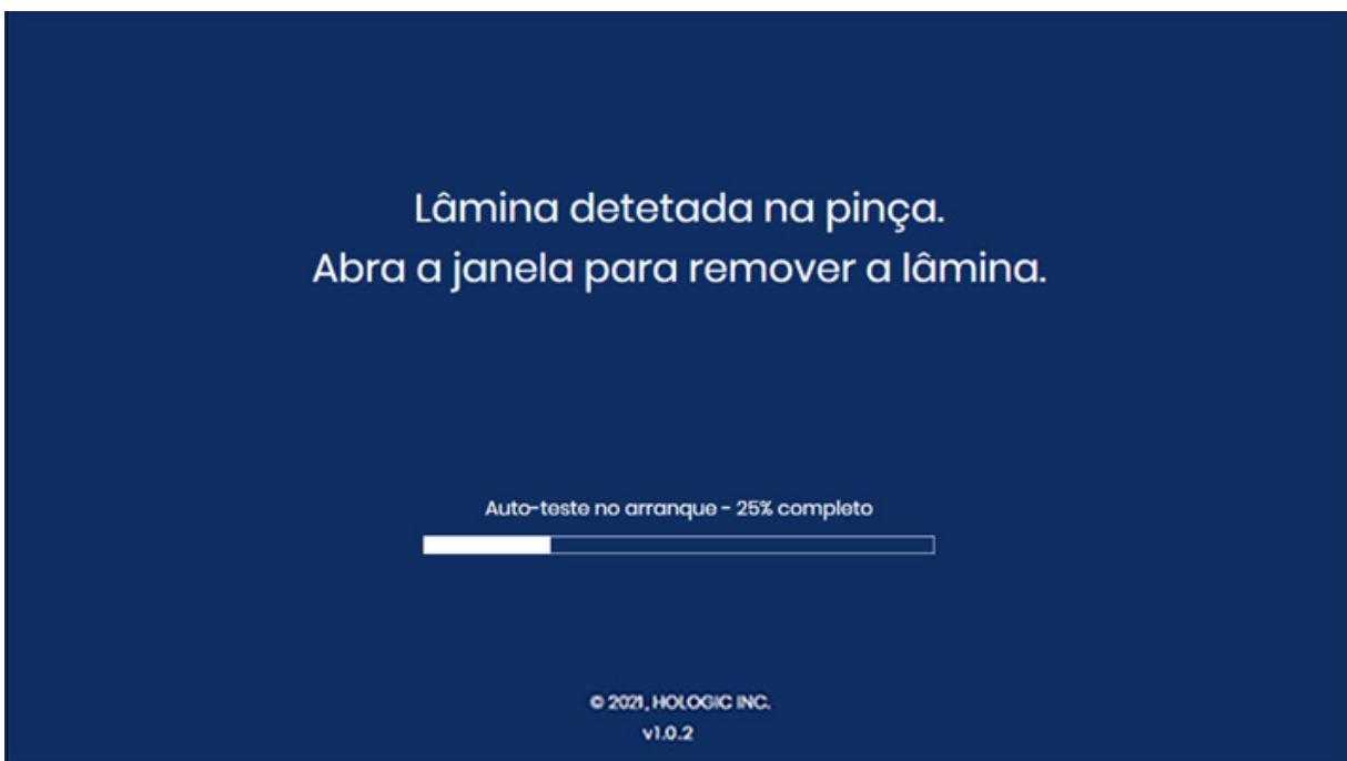
Figura 6-6 Recuperação do erro assistida pelo utilizador: abrir a janela para remover a lâmina
