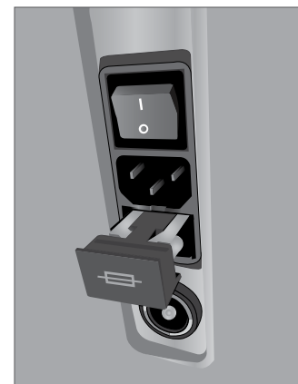
Ubicación del fusible
