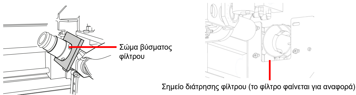
Εικόνα 8-4 Καθαρισμός του βύσματος του φίλτρου και της περιοχής διάτρησης του φίλτρου
