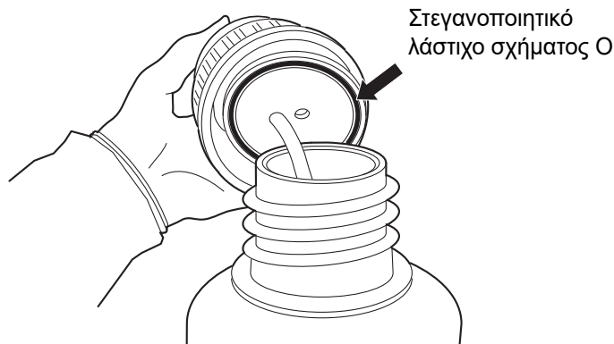
Εικόνα 8-11 Επιθεώρηση της στεγανότητας του λάστιχου σχήματος O της φιάλης αποβλήτων
