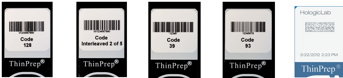
Kuva 7-3 Esimerkkejä siitä, miten viivakoodit sopivat ThinPrep-aluslasiin
