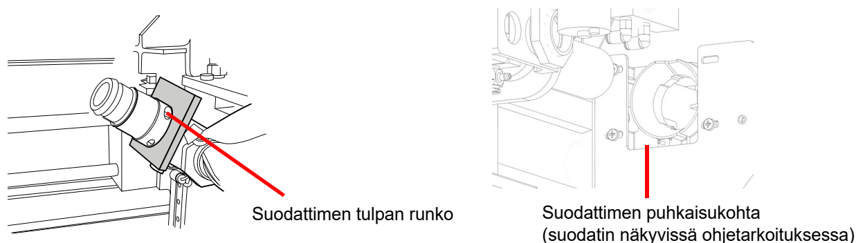
Kuva 8-4 Suodatintulpan ja suodattimen lävistysalueen ympäristön puhdistaminen
