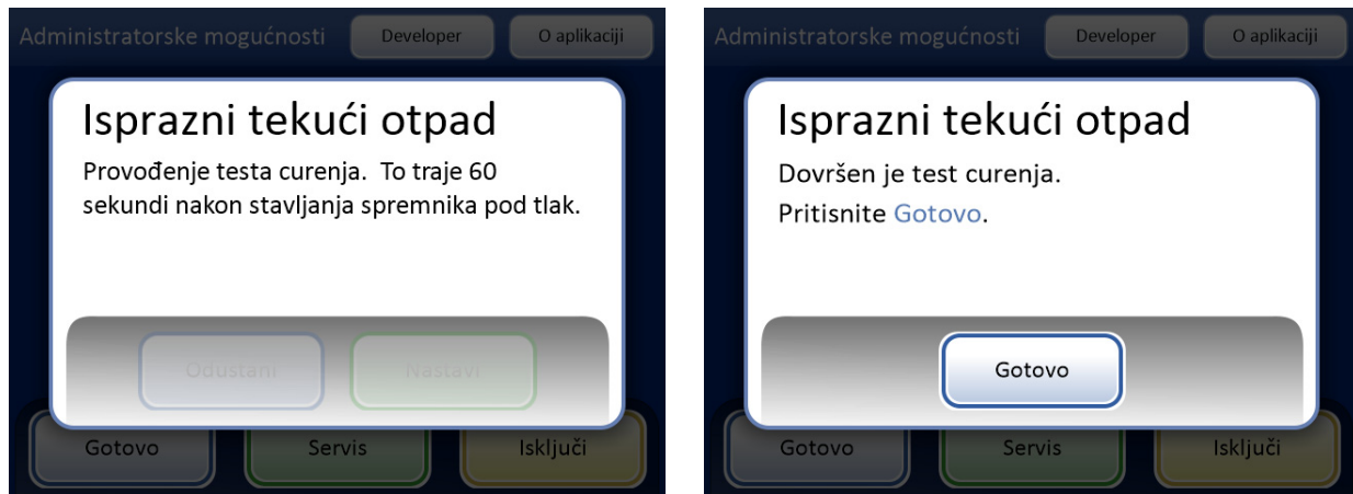
Slika 8-12 Test curenja sustava otpada
