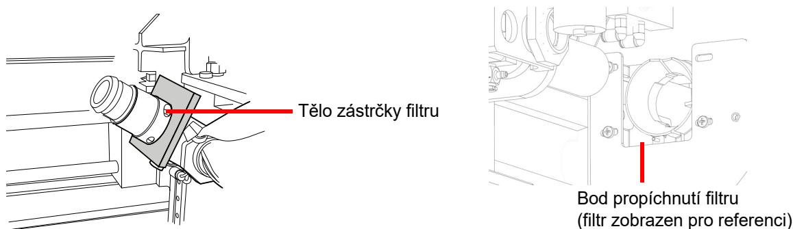
Obrázek 8-4 Čištění okolí zástrčky filtru a oblasti propíchnutí filtru
