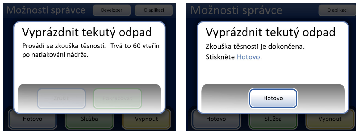
Obrázek 8-12 Zkouška těsnosti odpadního systému
