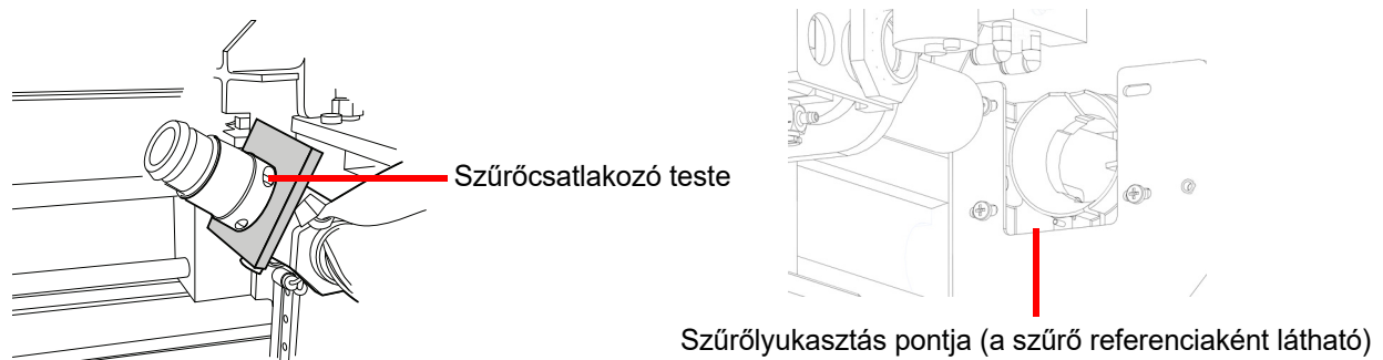
8-4. ábra Tisztítsa meg a szűrőcsatlakozó és a szűrőlyukasztás területét
