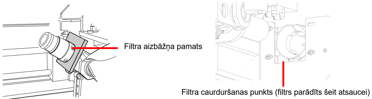
8-4 attēls. Iztīriet filtra aizbāzni un filtra pārduršanas zonu
