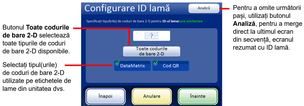
Figura 6-46 Specificați tipul(urile) de coduri de bare 2-D pentru ID-urile de lame etichetate în prealabil
