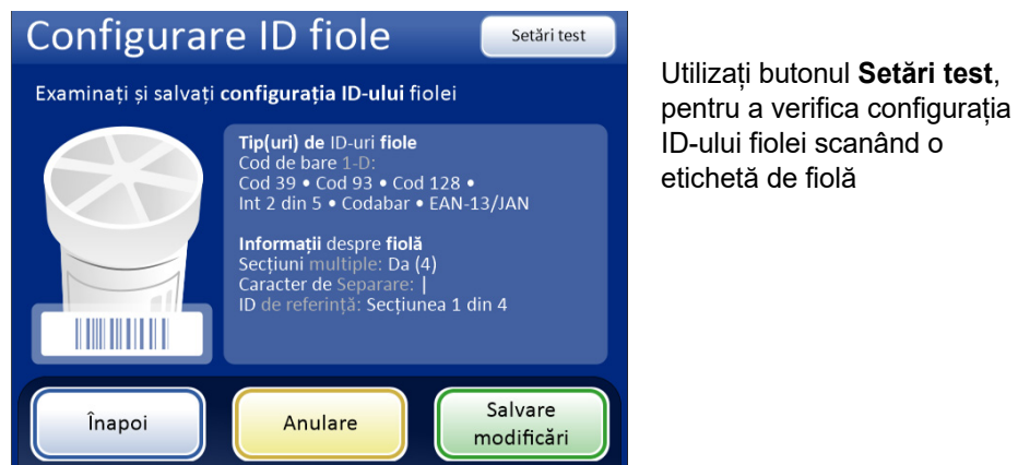
Figura 6-41 Configurarea ecranului de rezumare a ID-urilor fiolelor
