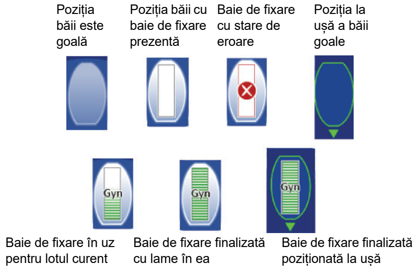
Figura 6-14 Starea băii de fixare - Lame Gineco ca exemplu
