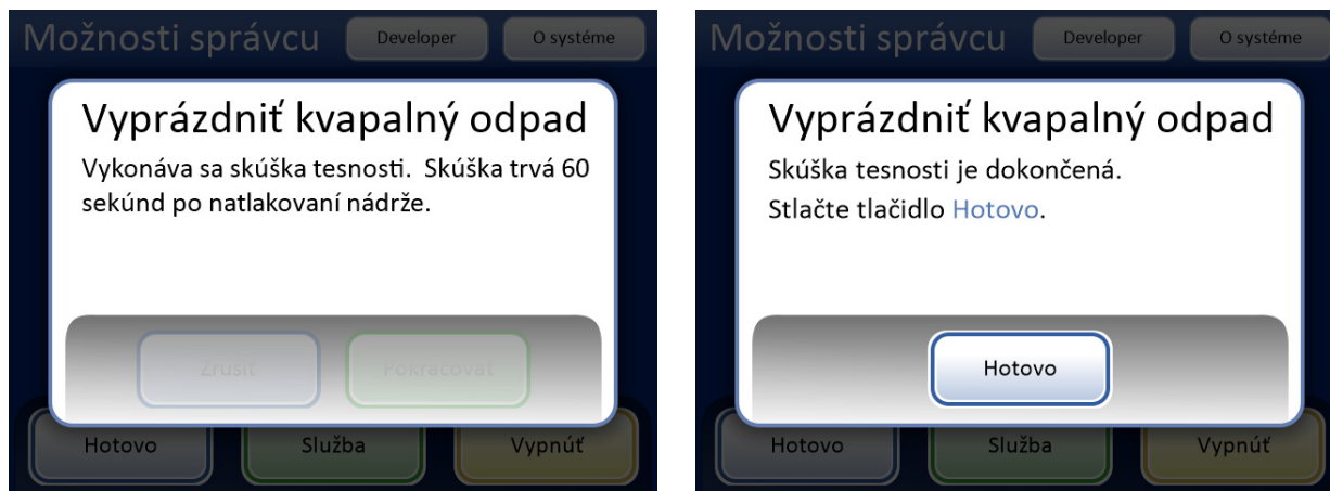
Obrázok 8-12 Skúška tesnosti odpadového systému
