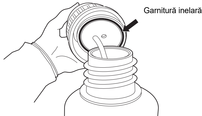
Figura 8-14 Inspectarea garniturii inelare a sticlei pentru deșeuri
