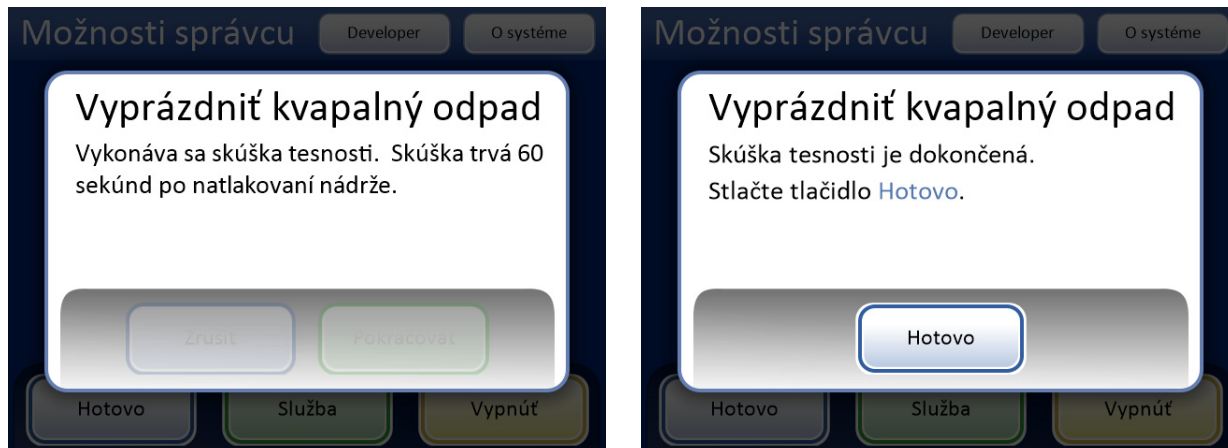
Obrázok 8-15 Skúška tesnosti odpadového systému
