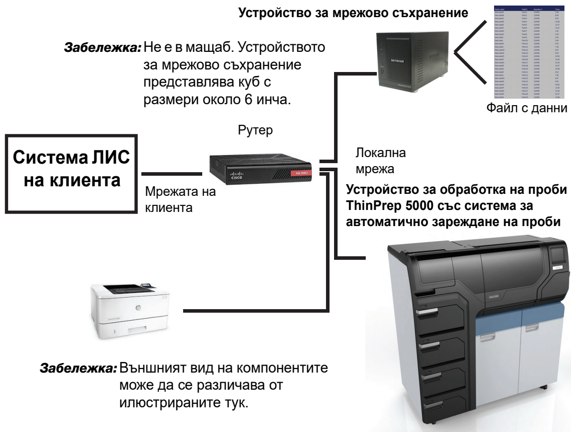
Фигура 2-2 Схема за свързване на локална мрежа (пример)
