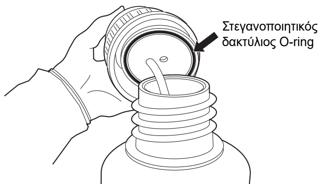
Εικόνα 8-16 Επιθεώρηση της στεγανότητας του δακτυλίου O-Ring της φιάλης αποβλήτων
