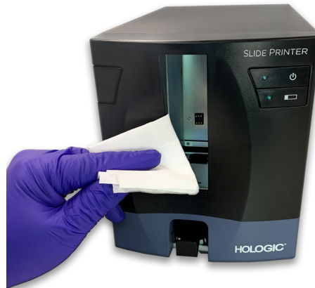
8-11. attēls. Notīriet priekšmetstikliņu printera ievades rullīti
