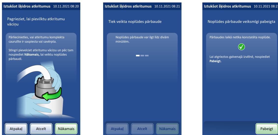
8-17. attēls. Vāciņa aizskrūvēšana un sistēmas noplūdes pārbaudes veikšana
