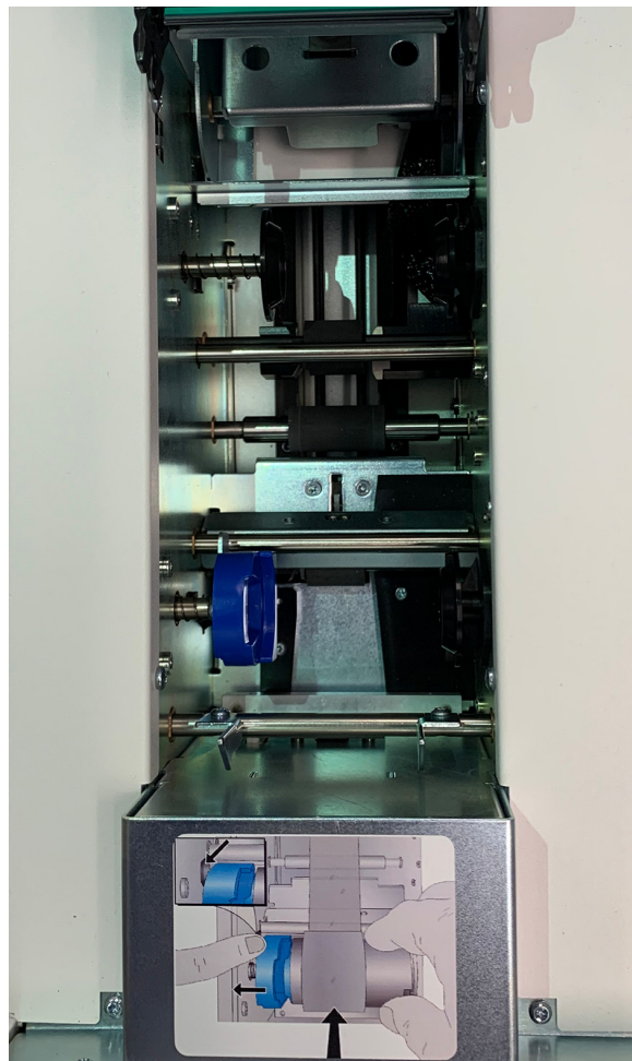
8–9 pav. Objektinių stiklelių spausdintuvo transportavimo ritinėliai
