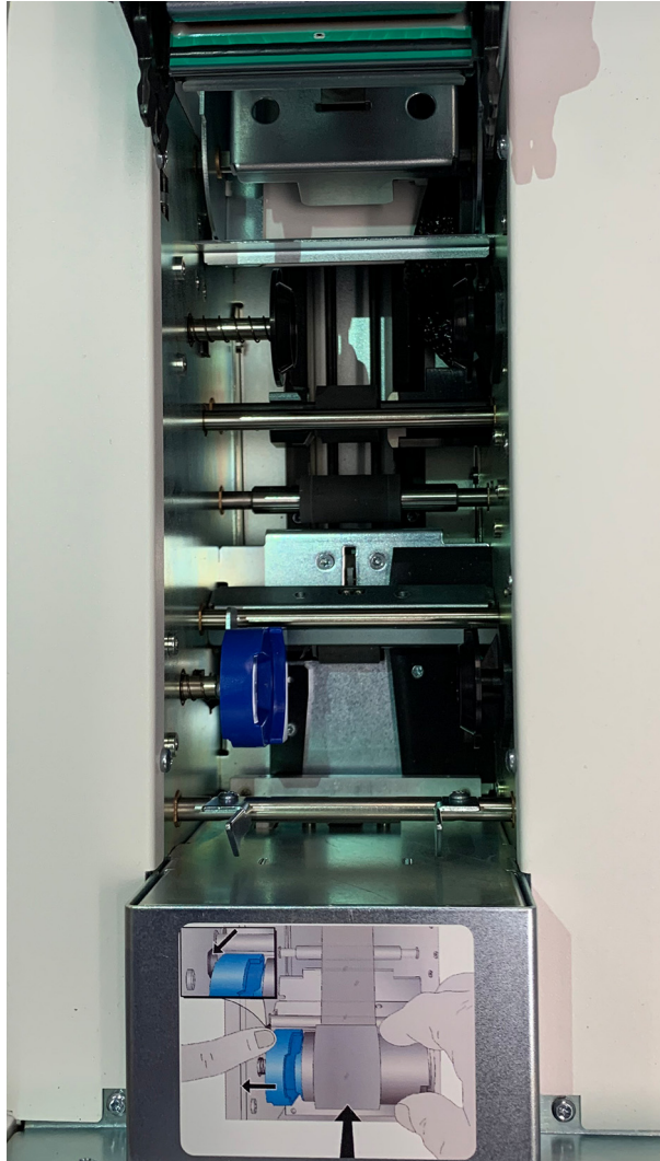
Figura 8-9 Role de transport ale imprimantei pentru lame
