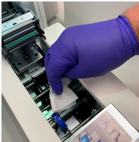
Figura 8-10 Ștergerea rolor de transport ale imprimantei pentru lame
