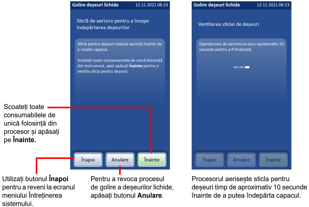
Figura 8-13 Dezactivarea sistemului pentru deșeuri
