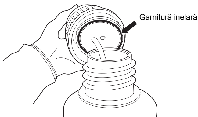
Figura 8-16 Inspectarea garniturii inelare a sticlei pentru deșeuri
