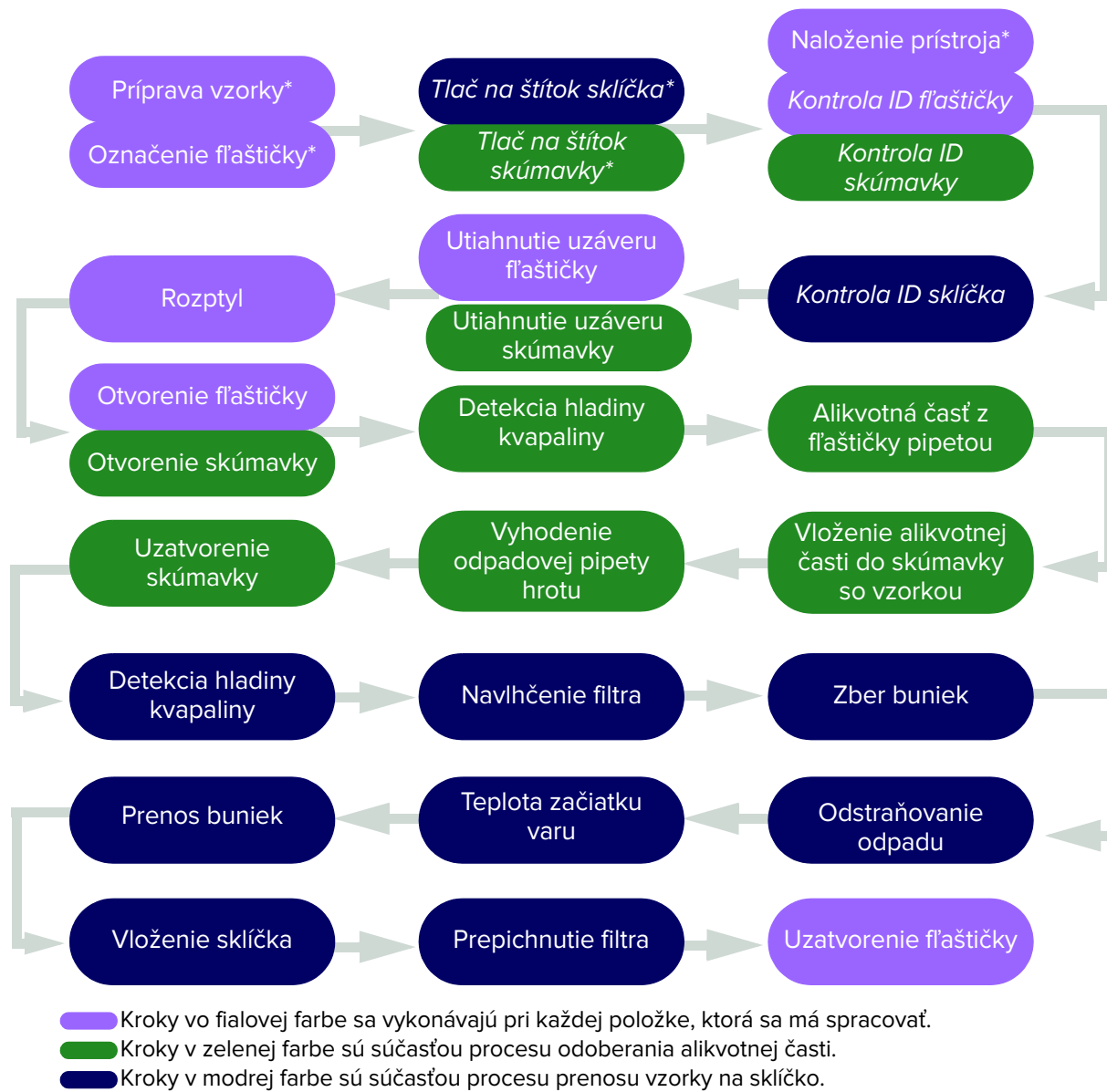
Obrázok 1-3 Spracovanie sklíčok a odobratie alikvotnej časti na procesore ThinPrep™ Genesis™
