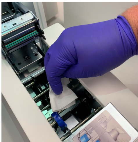
Obrázok 8-10 Utrite prepravné valčeky tlačiarne štítkov na sklíčka
