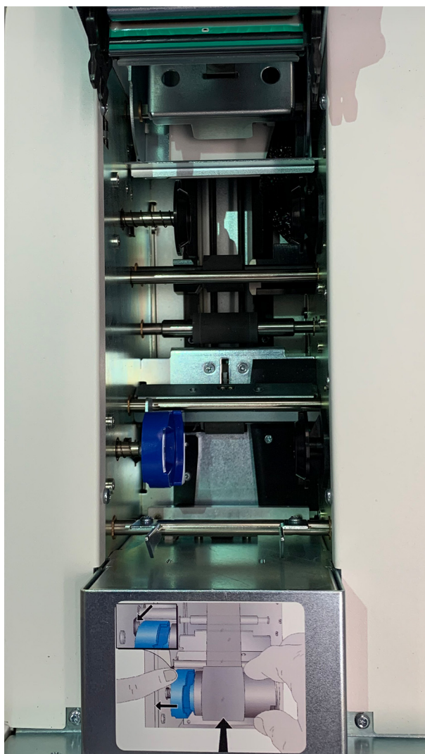
Obrázok 8-9 Prepravné valčeky tlačiarne štítkov na sklíčka
