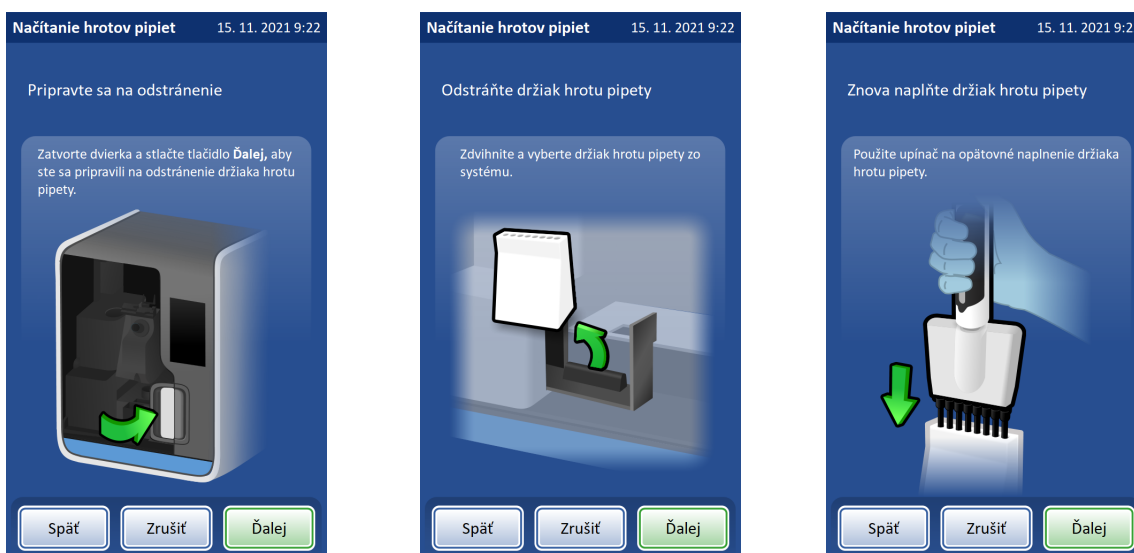
Obrázok 7-11 Vložte hroty pipiet do držiaka hrotov pipiet
