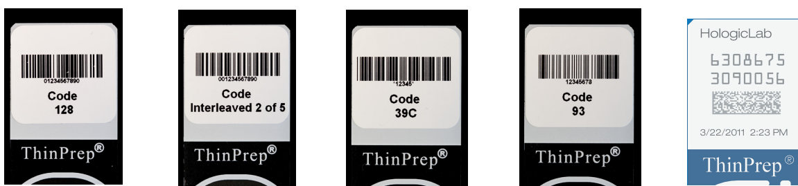
Obrázok 7-3 Príklady toho, ako sú čiarové kódy umiestnené na sklíčku ThinPrep
