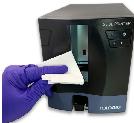
Slika 8-11 Očistite uvajalni valjček na tiskalniku za preparate
