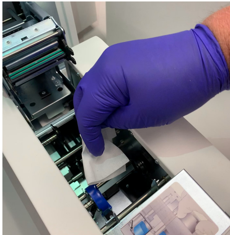
Slika 8-10 Obrišite transportne valjčke tiskalnika za preparate
