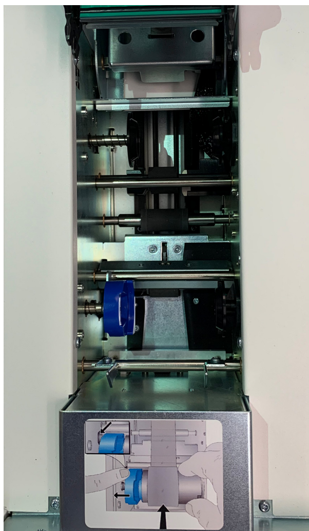
Slika 8-9 Transportni valjčki tiskalnika za preparate
