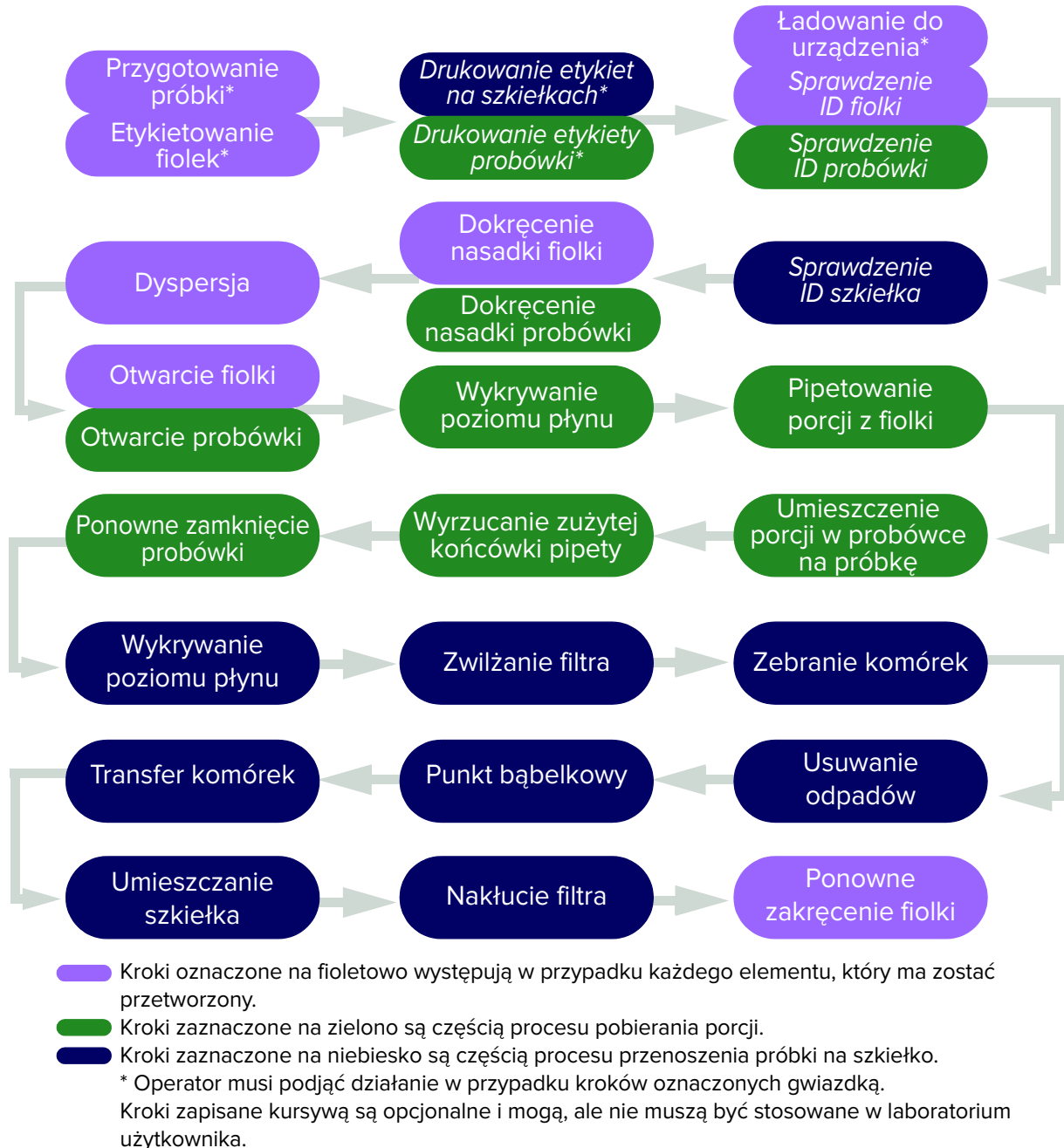
Rycina 1-3 Przetwarzanie szkiełek i pobieranie porcji w procesorze ThinPrep™ Genesis™
