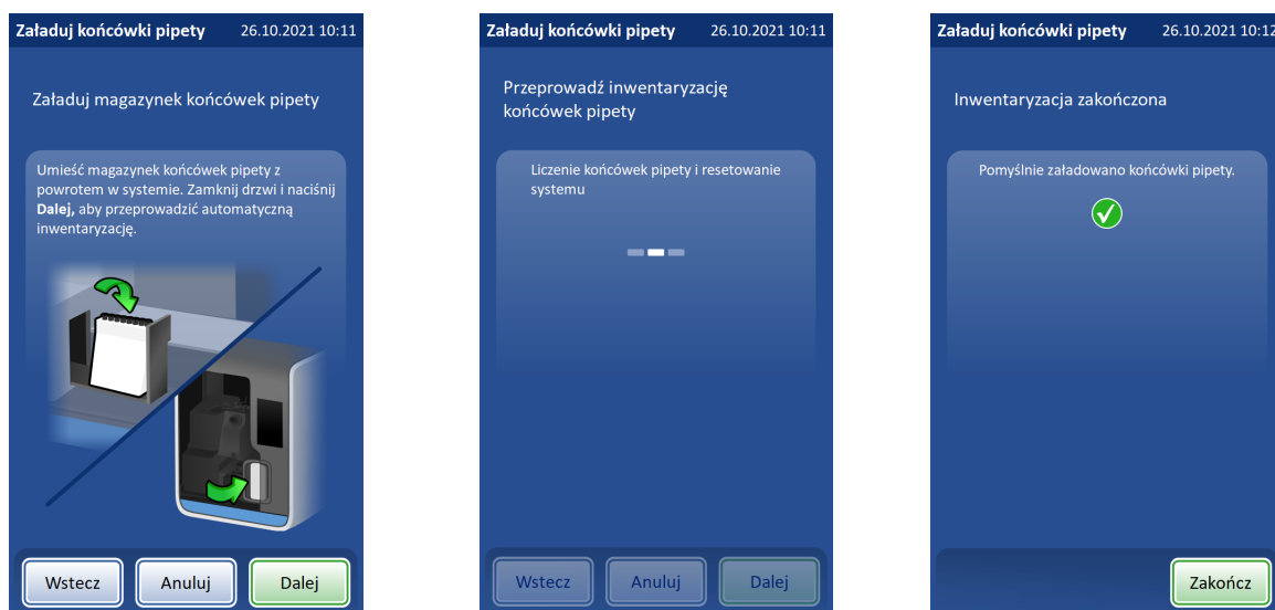
Rycina 7-12 Zwracanie załadowanego magazynka końcówek pipety
