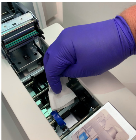
Rycina 8-10 Wycieranie rolek transportowych drukarki szkiełek
