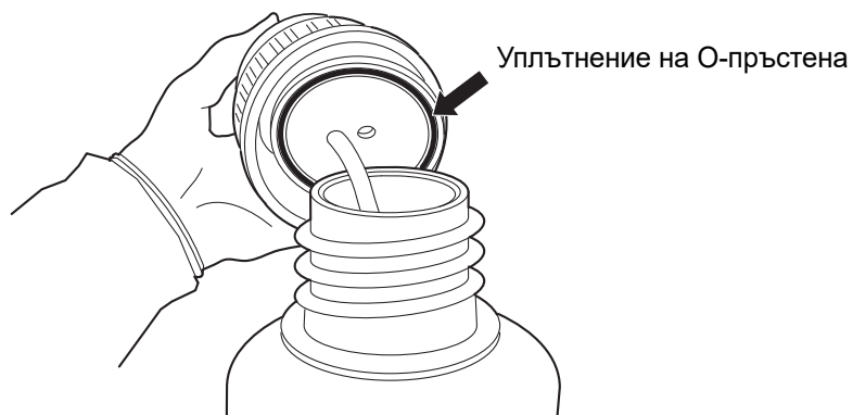
Фигура 8-16 Проверете уплътнението на О-пръстена на бутилката за отпадъци
