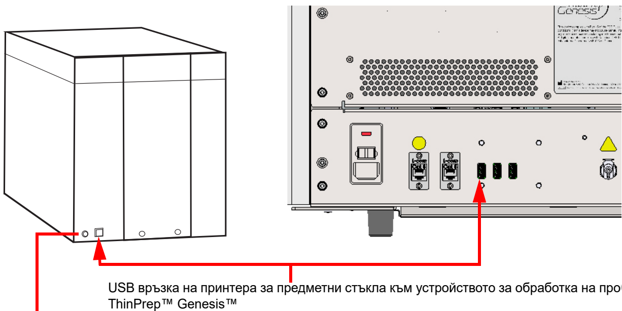
Фигура 8-25 Свържете принтера за предметни съгла към устройството за обработка на проби ThinPrep™ Genesis™
