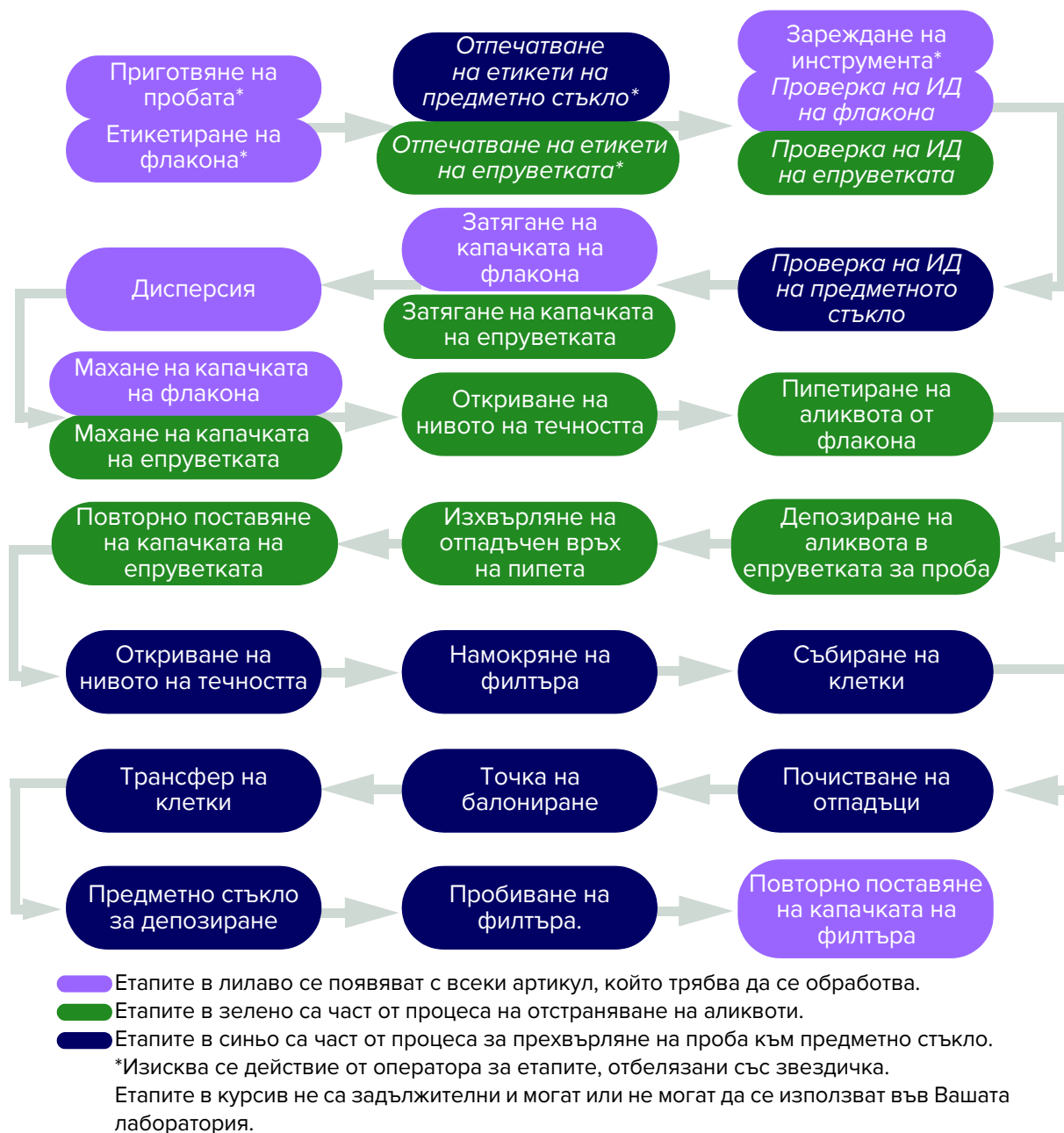
Фигура 1-3 Обработка на предметни стъкла и отстраняване на аликвоти в устройството за обработка на проби ThinPrep™ Genesis™
