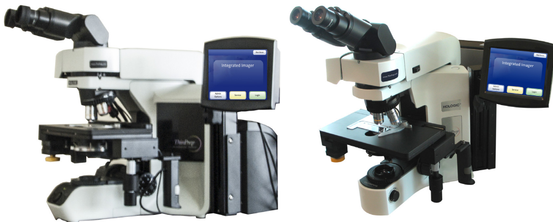
Kuva 1-1 Integroitu kuvageneraattori (kuvassa nähdään kaksi mikroskoopin runkokokoonpanoa)
