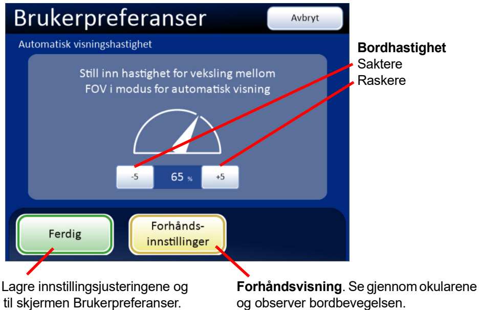
Figur 3-59 Justering av automatisk visningshastighet
