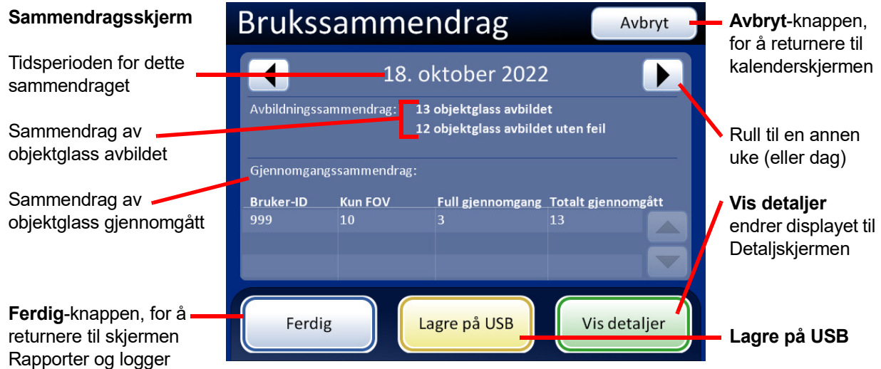
Figur 3-32 Skjermen Brukssammendrag (en ukentlig historikk vises)
