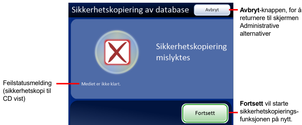
Figur 6-2 Skjermen Sikkerhetskopiering av database mislyktes
