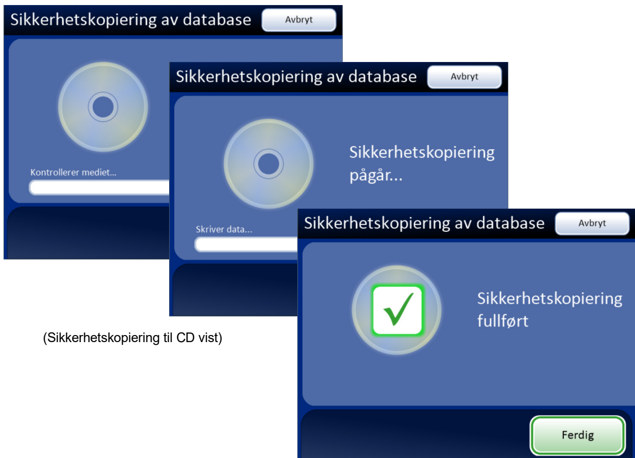
Figur 3-41 Sikkerhetskopiering av database
