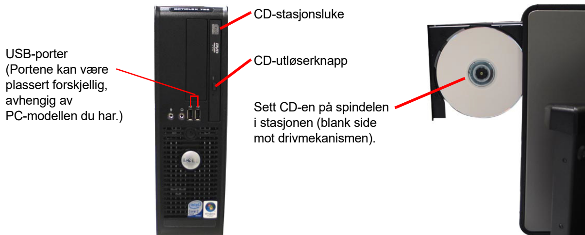
Figur 3-40 USB og CD: Åpne CD-stasjonen – sett inn platen
