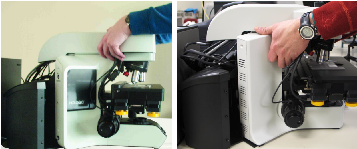
Slika 2-3 Premještanje instrumenta Integrated Imager (prikazane su dvije konfiguracije okvira mikroskopa)
