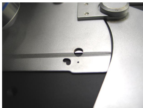
Figura 5-1 Características de comprobaciones funcionales que hay que mantener limpias.
