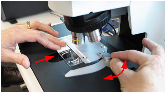
Use el botón para abrir la abrazadera del portaobjetos. Cargue el portaobjetos. Suelte la abrazadera del portaobjetos.
