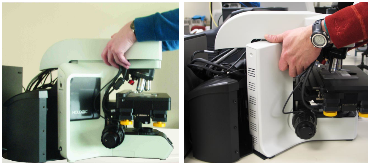
Figura 2-3 Mutarea microscopului Integrated Imager (sunt prezentate două configurații de cadre pentru microscop)
