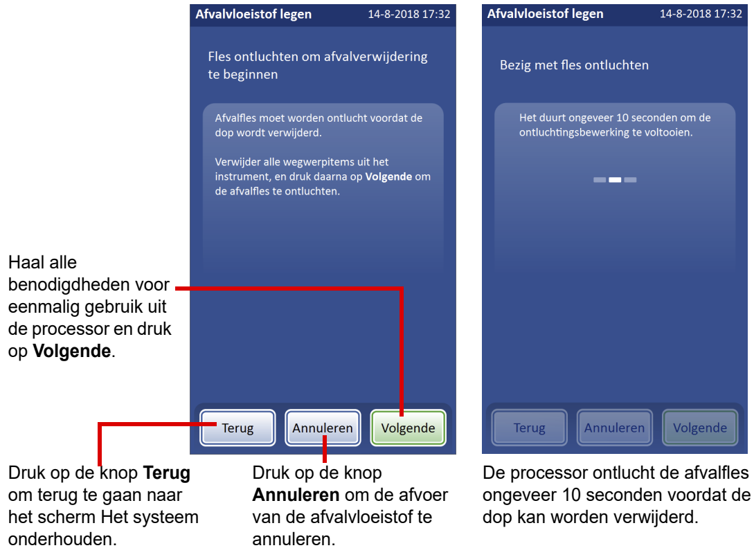
Afbeelding 8-13 Uitschakelen van het afvalstelsel
