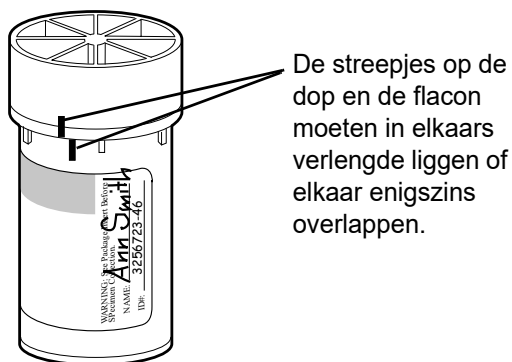
Afbeelding 3-1 De markeringen op dop en flacon op één lijn brengen
