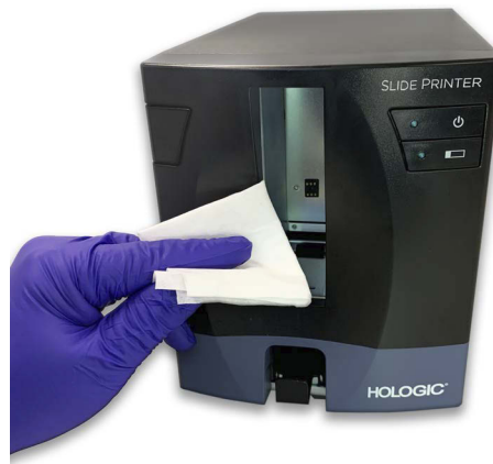
Afbeelding 8-11 De invoerrol van de glaasjesprinter reinigen
