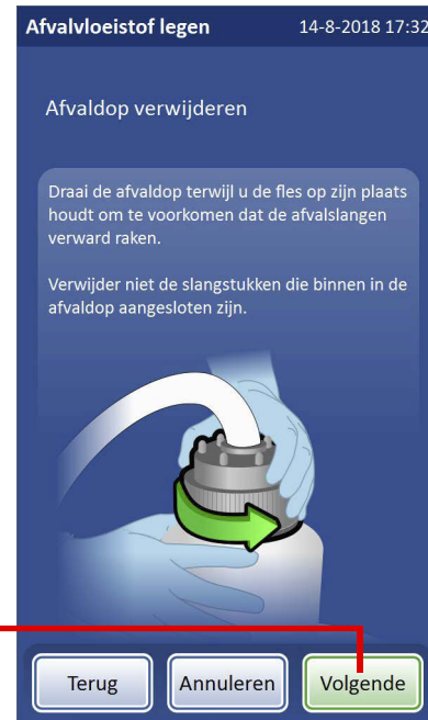
Afbeelding 8-14 Openen en sluiten van de afvalfles
