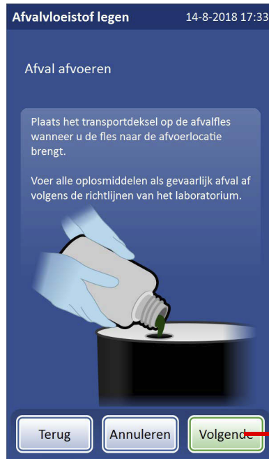
Afbeelding 8-15 Afvoeren van de inhoud van de afvalfles
