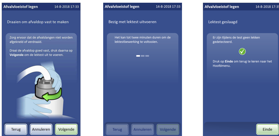
Afbeelding 8-17 Vastdraaien van afvaldop en uitvoeren van lektest
