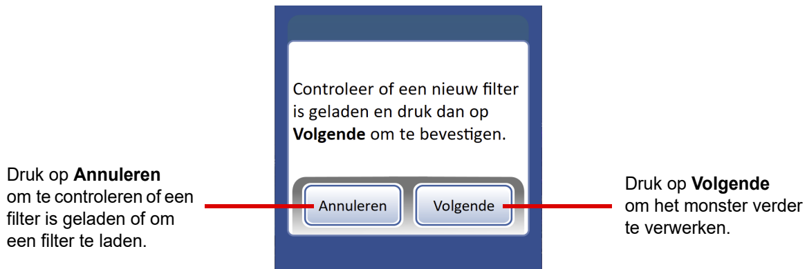
Afbeelding 9-1 Bevestigen dat er een filter in de processor is geladen
