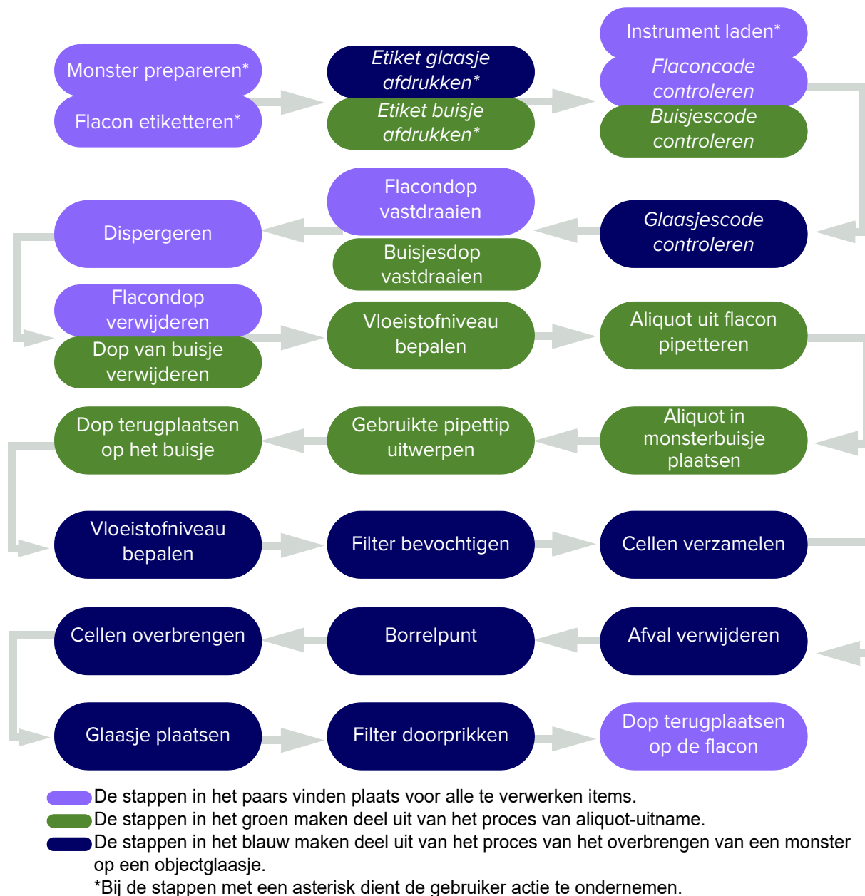
Afbeelding 1-3 Een glaasje verwerken en een aliquot uitnemen met de ThinPrep™ Genesis™-processor
