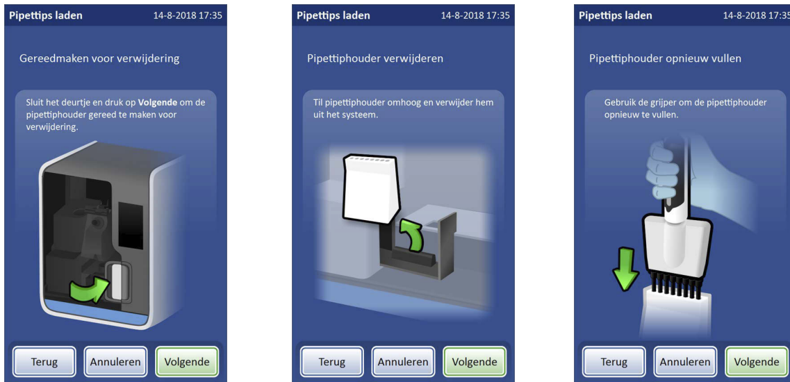
Afbeelding 7-11 Pipettips in de pipettiphouder laden
