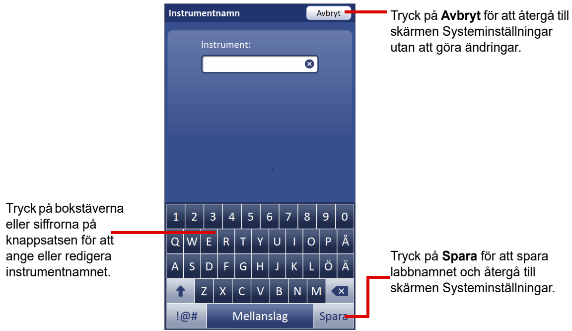
Figur 6-20 Ange eller redigera instrumentnamnet via knappsatsen
