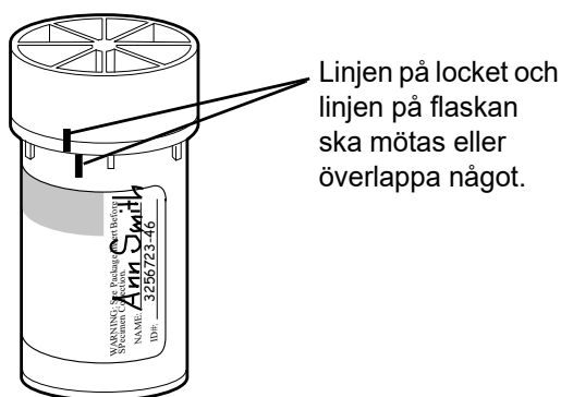
Figur 3-1 Inriktning av flasklocket
