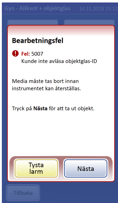
Figur 6-33 Spårbarhet på – Processorn skannar och jämför objektglas-ID
