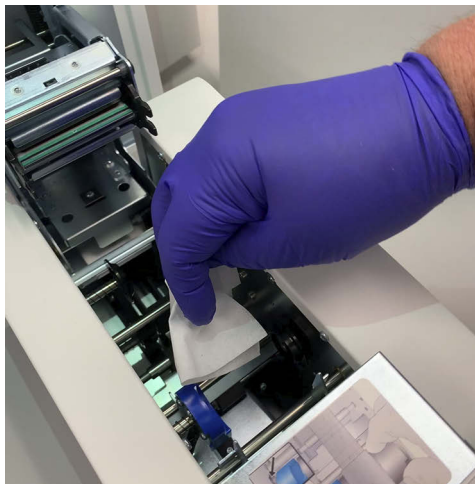
Figur 8-10 Torka av transportrullar för objektglasskrivare
