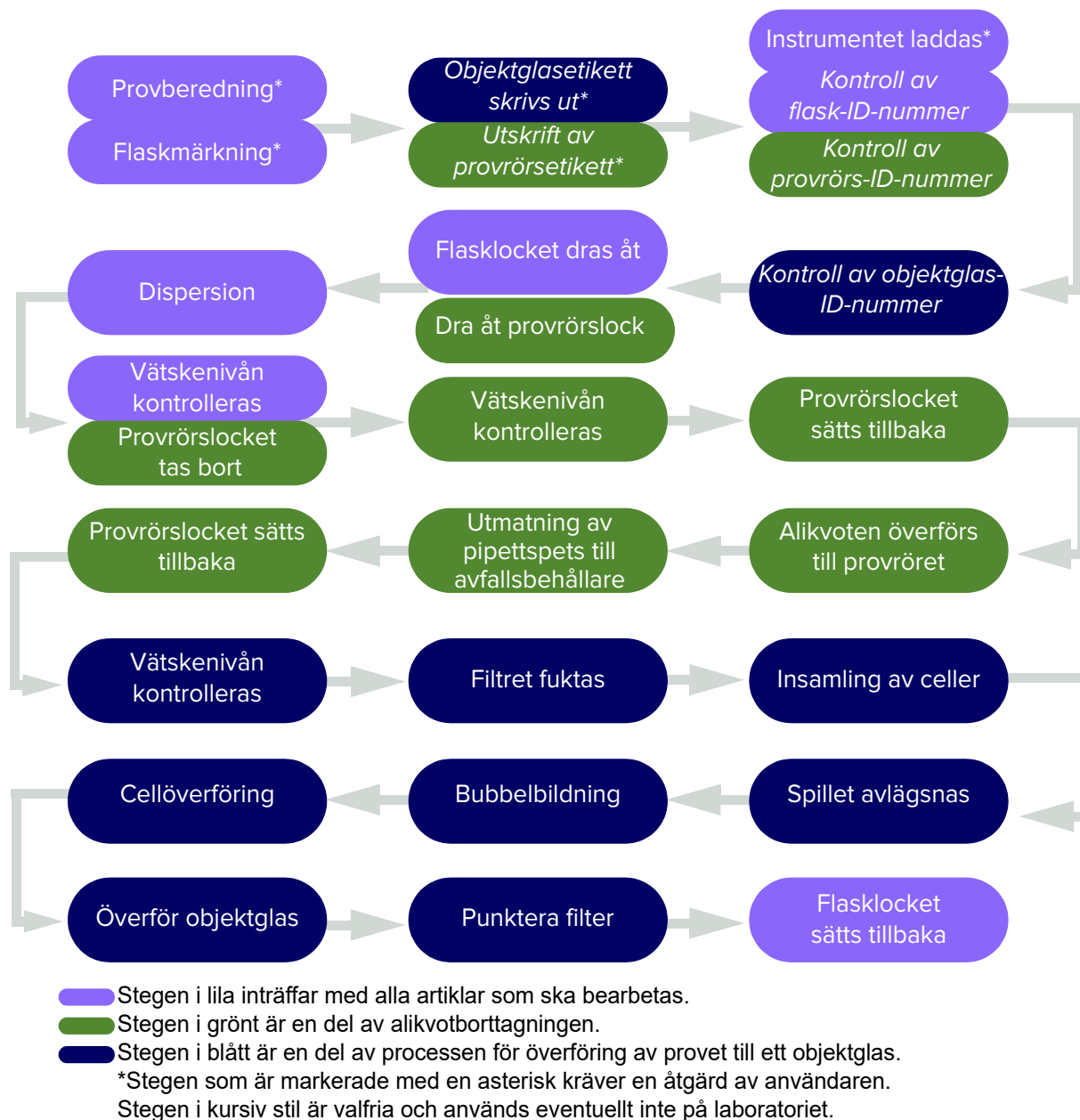
Figur 1-3 Objektglasbearbetning och alikvotborttagning med ThinPrep™ Genesis™-processorn
