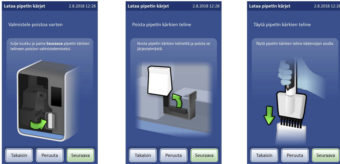
Kuva 7-11 Aseta pipetin kärjet pipetin kärkien telineeseen
