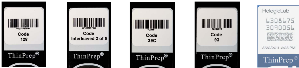
Kuva 7-3 Esimerkkejä siitä, miten viivakoodit sopivat ThinPrep-aluslasille
