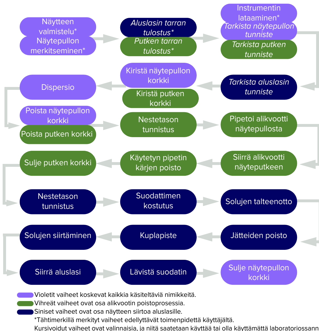
Kuva 1-3 Aluslasin käsittely ja alikvootin poisto ThinPrep™ Genesis™ -prosessointilaitteella
