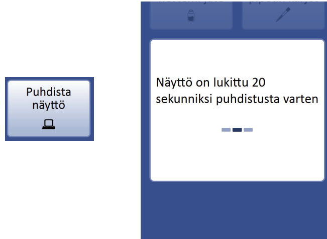
Kuva 8-5 Kosketusnäyttö poistettu käytöstä puhdistamista varten
