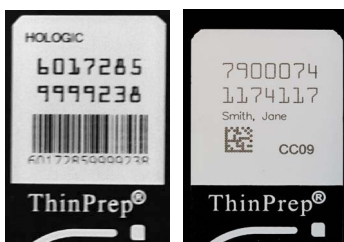
Kuva 7-4 Esimerkki OCR-viivakoodeista ThinPrep-aluslasilla
