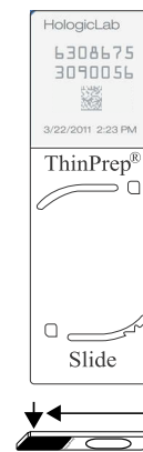
Kuva 7-17 Lataa aluslasi siten, että tarrapuoli on vasemmalla ja tarra on alaspäin
