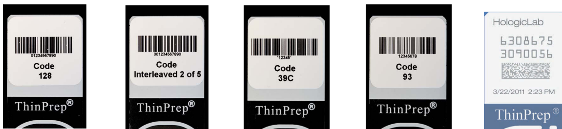
Figur 7-3 Eksempler på hvordan ulike strekkoder får plass på et ThinPrep-objektglass
