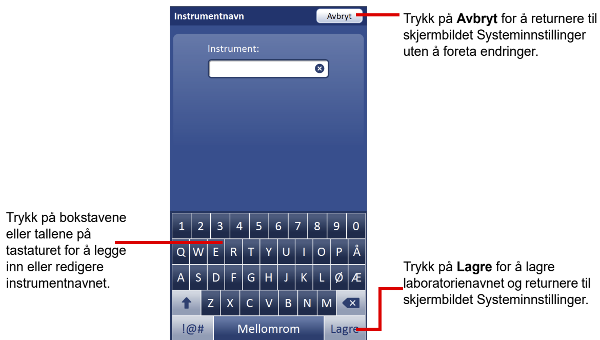
Figur 6-20 Legg inn eller rediger instrumentnavnet ved hjelp av tastaturet
