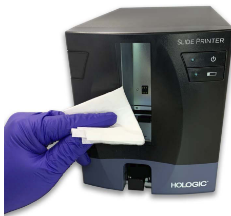
Figur 8-11 Rengjør innmatingsvalsen på objektglasskriveren
