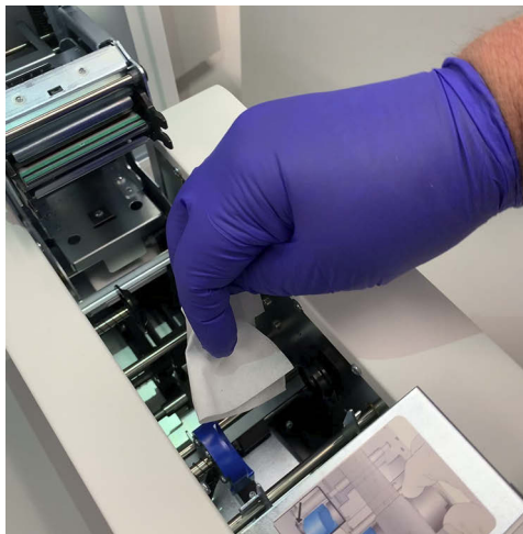
Figur 8-10 Tørk av objektglasskriverens transportvalser
