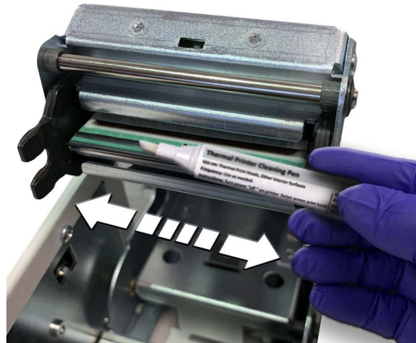
Figur 8-7 Stryk rengjøringspennen over objektglasskriverens skrivehode
