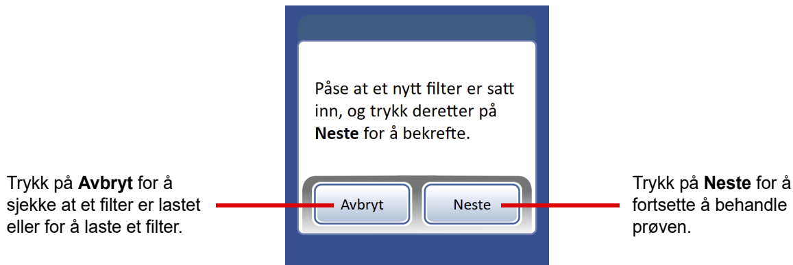
Figur 9-1 Bekrefte at et filter er lastet inn i prosessoren
