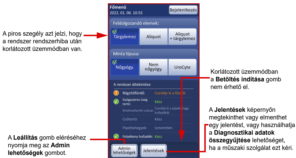
9-13 ábra. Korlátozott üzemmód, Főmenü képernyő
