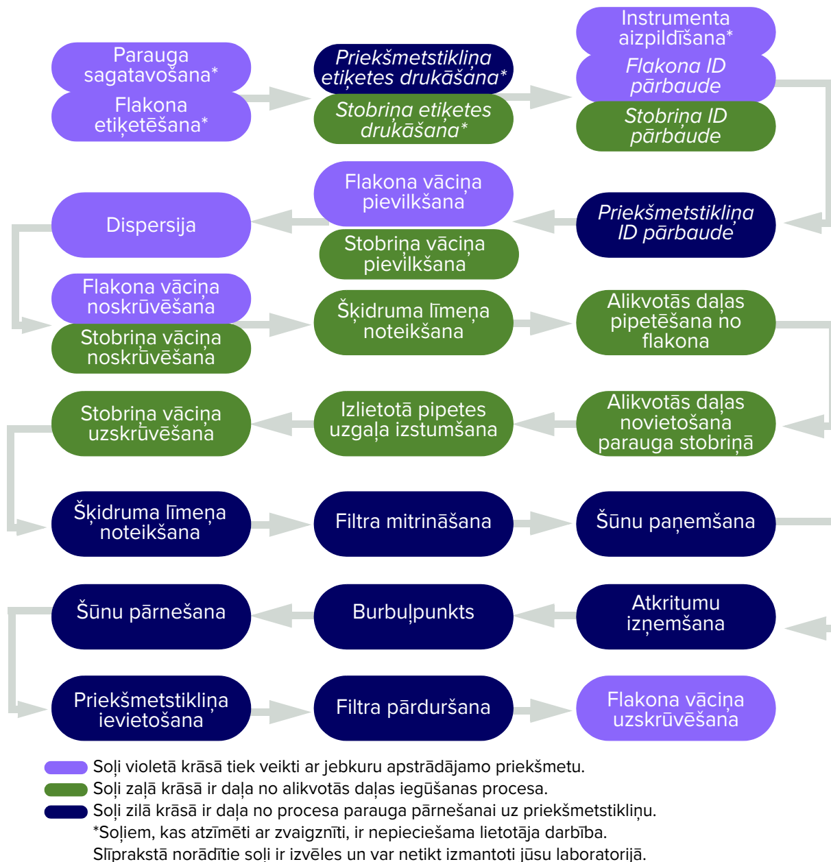
1-3. attēls. Priekšmetstikliņu sagatavošana un alikvoto daļu iegūšana ar ThinPrep™ Genesis™ apstrādātāju
