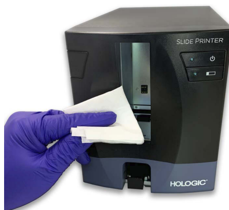
8-11. attēls. Notīriet priekšmetstikliņu printera ievades rullīti
