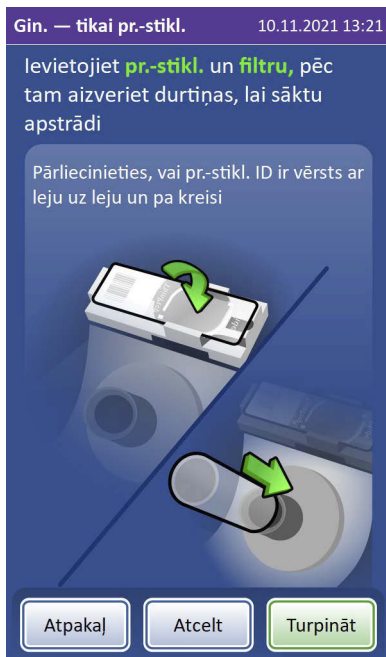
7-16. attēls. Priekšmetstikliņa un filtra ievietošana
