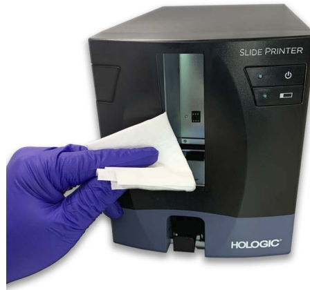
Figura 8-11 Limpieza del rodillo de entrada en la impresora de portaobjetos
