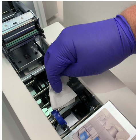
Figura 8-10 Limpiar los rodillos de transporte de la impresora de portaobjetos
