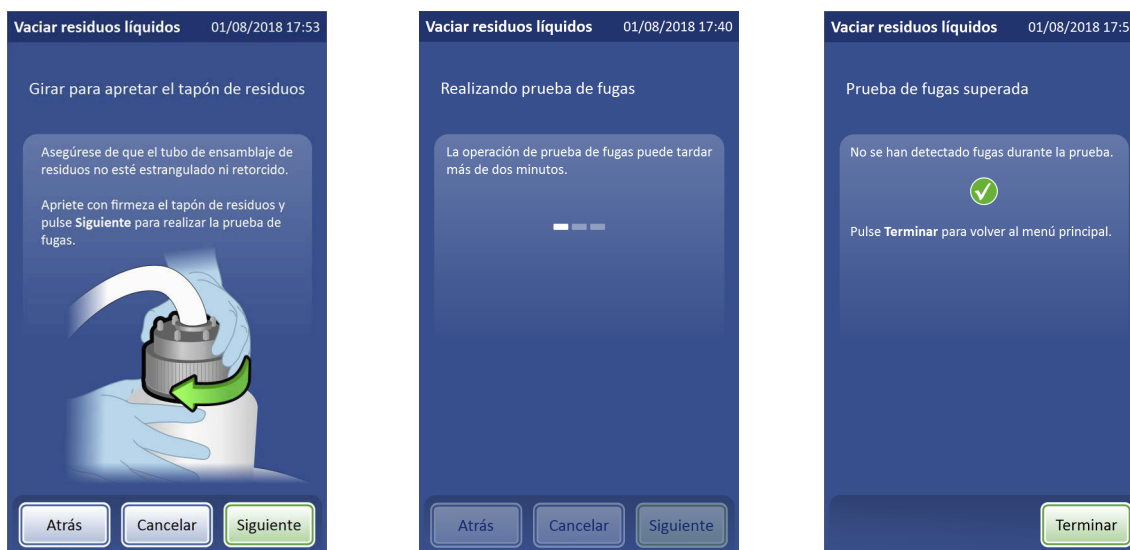
Figura 8-17 Apriete el tapón y realice la prueba de fugas del sistema de desechos
